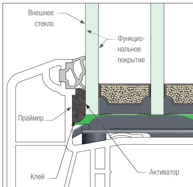
Конструкция вклеивания остекления в створку
